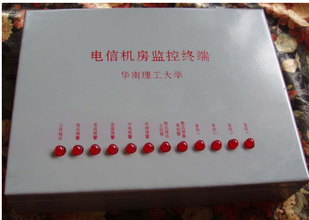
图 2 监控器实物图
